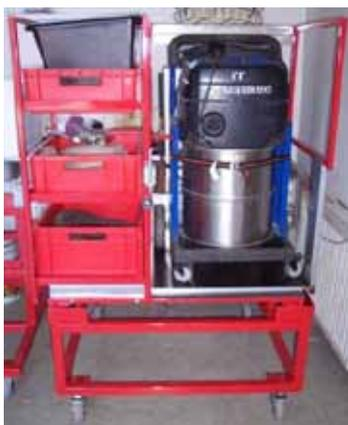
Dank Wechselrahmen kann das Löschgerät entfernt und unser Restlossauger eingeschoben werden.
