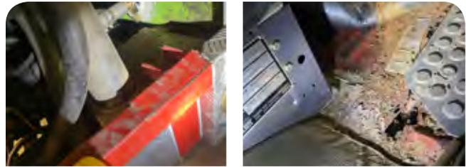
Gerissener Rahmen und durchgerostete Bodenplatte beim Beifahrer
